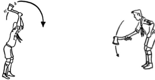
A machadinha, por poder ser usada apenas com uma mão, deve ser pega na ponta do cabo, e não meio do cabo. Tem-se melhor balanço, e é preciso fazer-se menos força.
