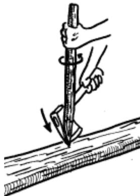
Uma estaca deve ter a parte de trás ligeiramente desbastada, como na figura acima, para evitar que, ao bater nela, se desfaça.
