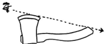
Para evitar que o cabo rache ao bater com a ponta numa superfície dura, devemos cortar essa mesma ponta.
