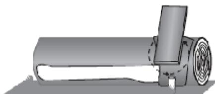
Se a lâmina tiver fissuras, devemos começar usando um lima para fazer desaparecer, e só depois usar a pedra de esmeril.
