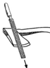
Quando estiver desbastando a lâmina do machado, para retirar as fissuras, tenha cuidado. O fio da lâmina deve ficar com uma forma nem muito longa nem muito curta. Observe a figura para ver qual é a melhor forma.
