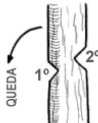
Para cortar uma vara verde, segure pela parte de cima para envergar. Os golpes devem ser dados com inclinação de 60° e não perpendicularmente à vara. Vergar a vara aumenta o efeito de corte do machado.
